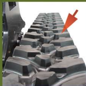
Profil des chenilles conçu pour la flottaison et la charge.
