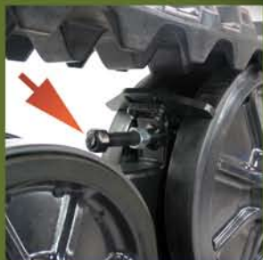
Ajustement de la tension de la chenille simple et accessible.
